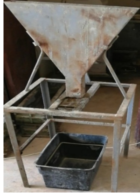
الشكل رقم 8: جهاز القمع حرف-VV-Funnel
