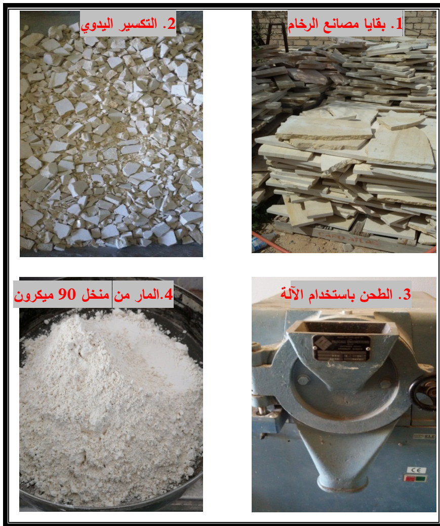
الشكل رقم 1: طريقة طحن الرخام
