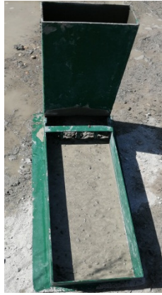
الشكل رقم 10: اختبار الصندوق حرف - L
