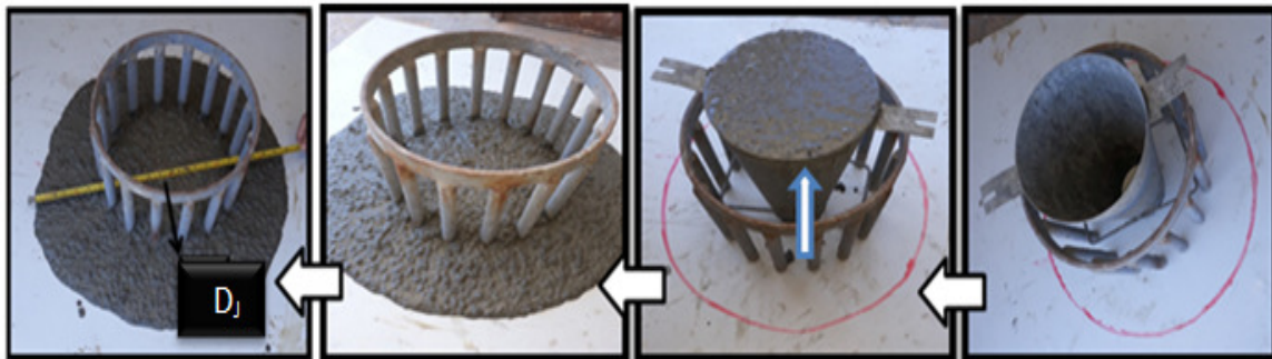
الشكل (10) يوضح طريقة إجراء اختبار J-Ring
