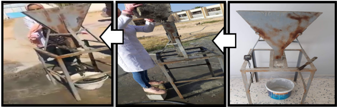
الشكل (12) يوضح طريقة إجراء اختبار V-Funnel
