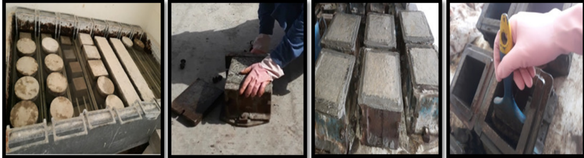
الشكل (6) يوضح العينات الخرسانية بعد صبها ومعالجتها.
