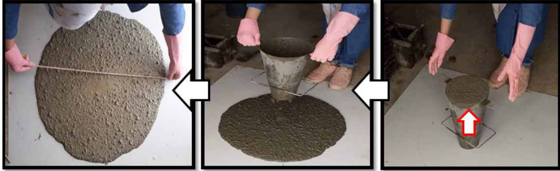
الشكل (8) يوضح طريقة إجراء اختبار الهبوط (Slump Flow)
